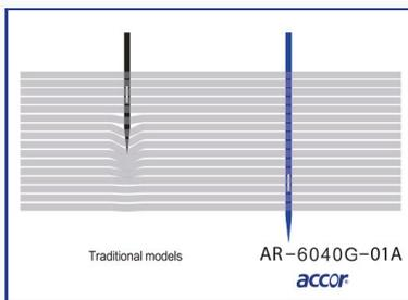
Équipé d'un moteur haute puissance de 750 W, peut jouer une forte pénétration de l'aiguille. Lorsque la résistance à la pénétration est encore augmentée, grâce au contrôle des vibrations (impact intermittent), améliore automatiquement la pénétration.
