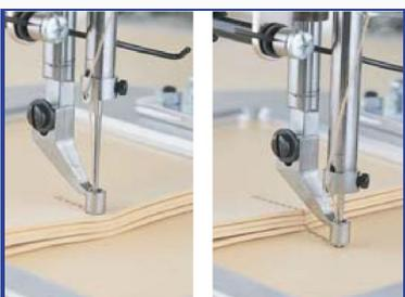
Pour obtenir un point stable en basse tension. De plus, comme la hauteur du pied-de-biche intermittent peut être modifiée, même si l'épaisseur du tissu change, il n'y a pas de cas où le pressage n'est pas en place ou le pressage est excessif, afin d'assurer une prise uniforme et stable -up effet.
