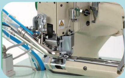
Le coupe-chaîne de type pneumatique breveté s'installe facilement et fonctionne de manière pratique, ce qui pourrait couper fil et ruban pour augmenter la qualité et l'efficacité de la production de vêtements
