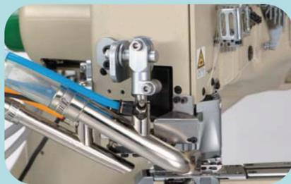
Adaptateur de dispositif d'aspiration multi-réglable qui dépend de la demande du client pour s'ajuster à un angle précis
