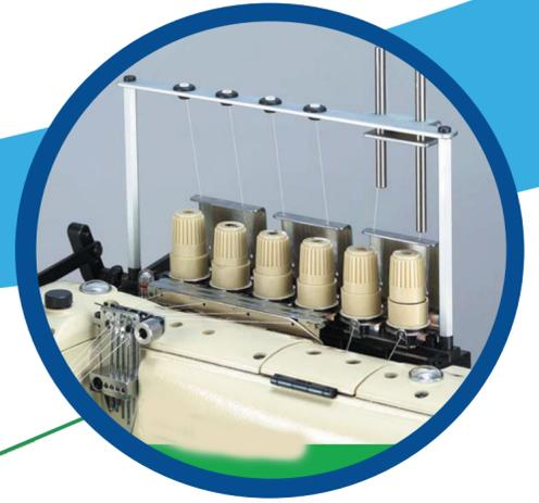
pour réduire la distance entre le support de fil et la machine et offrir une alimentation en fil et une tension plus douces.
