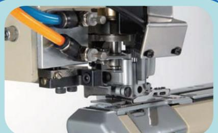
Le coupeur micro-réglable pourrait suivre l'opération pour s'ajuster avec précision
