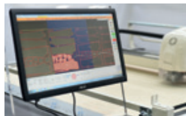
Ecran ISO permettant de visualiser la découpe à effectuer, les encoches, points de perçage, les lignes.
